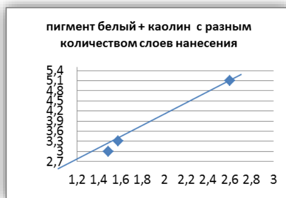
Рис. 3 – Цветовые характеристики дублированных образцов: а – при концентрациях пигмента белого от 50 до 200 г/кг; б – при различном количестве нанесенных слоев композиции, включающей пигмент белый и каолин в соотношении 5:1.
