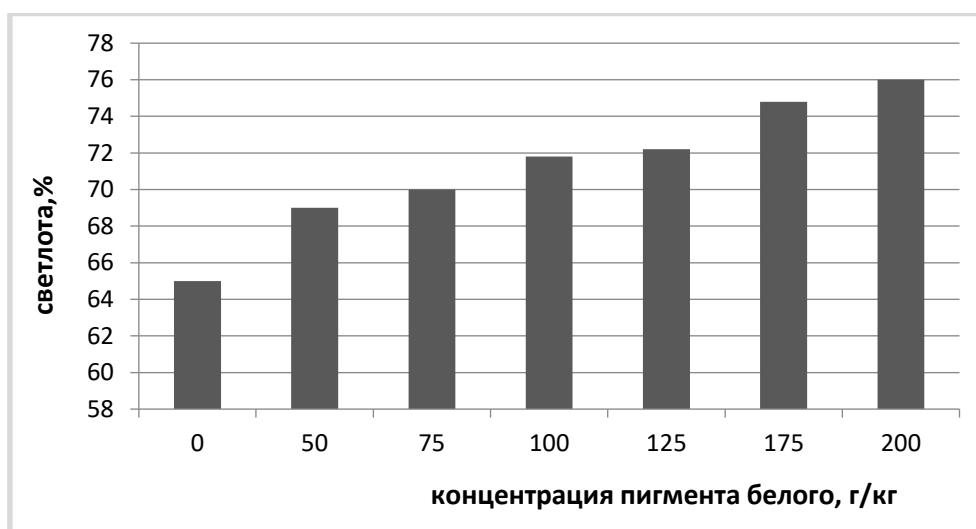
Рис. 2 – Зависимость показателя светлоты L от концентрации пигмента в полимерно-клеевой композиции.
